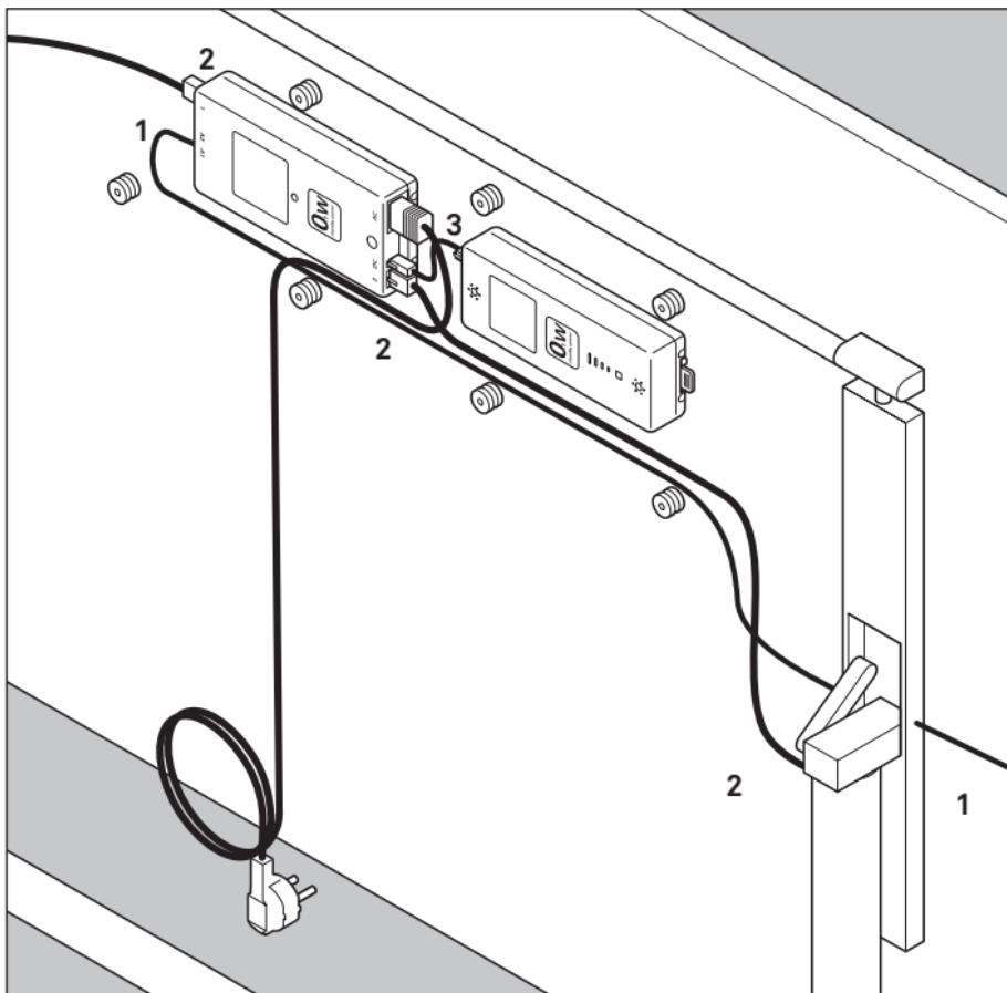
• Alle Komponenten des Systems müssen untereinander verbunden sein, bevor die Steuereinheit ans Stromnetz angeschlossen wird: das Bedienelement in der Plattenoberseite (1), die Motoren (2), die Steuereinheit und der optionale Akku (3).
