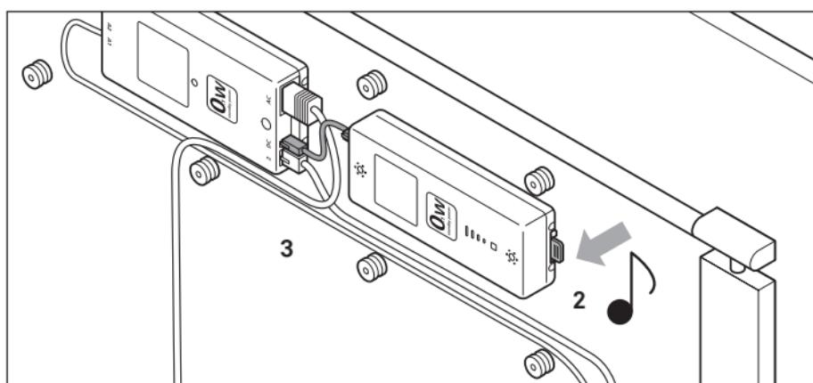
• En el momento de la entrega y si se incluye en su modelo, la batería ya está montada en el carril de montaje, pero no conectada a la unidad de control. Antes de la primera puesta en servicio, siga el paso 2 de las siguientes instrucciones para el montaje de las baterías:
