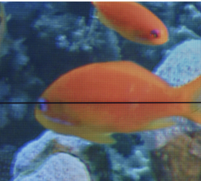
Der Selbstausrichtung der UniSee Mount garantiert die schmalst-mögliche Lücke
